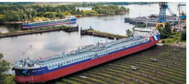
21 июля на заводе «Красное Сормово» состоялась торжественная церемония спуска на воду танкера-химовоза проекта RST27M для компании «БФ Танкер». Судно такого проекта было построено впервые. Уникальность его состоит в том, что грузоподъемность судна увеличена на 800 тонн, а одним рейсом можно перевозить до трех сортов грузов.
